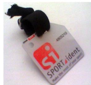
2. Участник в предстартовой зоне ДОЛЖЕН ОЧИСТИТЬ ЧИП В СТАНЦИИ ОЧИСТКИ. Очистка длится около 2-5 сек. По окончании очистки звучит звуковой сигнал и срабатывают световые индикаторы.
