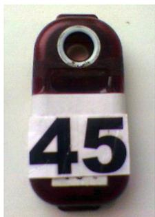
3. Отметка на станции, находящейся на КП, длится 0,3 сек. Производится ЛЮБОЙ стороной карточки-ЧИПа. По её окончании раздается звуковой сигнал и зажигаются световые индикаторы. Участник обязательно должен дождаться сигнала станции об его отметке!
